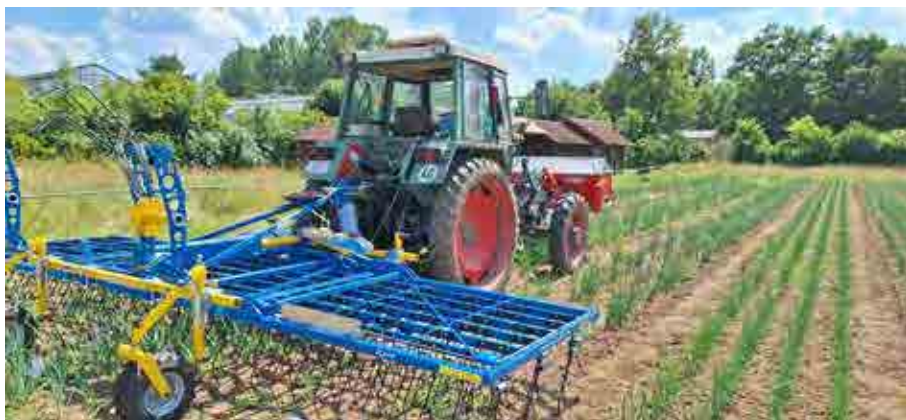
Mithilfe des Striegels werden durch die Erdbewegung Unkräuter im Keimblatt- oder Keimstadium effektiv bekämpft. Wöchentliches Striegeln mit hoher Geschwindigkeit führt jedoch zu Verlusten bei der Zwiebel (rechts). Fotos: © LLH
